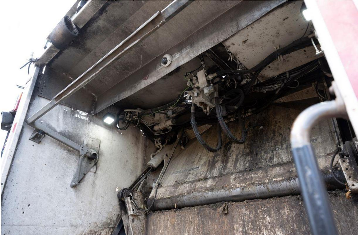
*Une caméra filme à haute fréquence d'image les biodéchets qui sont déversés dans la benne.*
